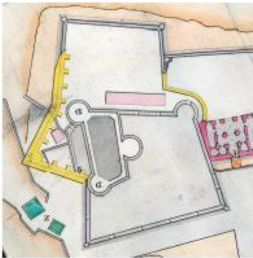
Fig. 15. Sector del plano y proyecto del castillo de Rosalcazar que manifiesta el actual estado de su obra en el mes de julio del año 1765, Joseph Dufresne. IHCM, Cartoteca, ORA O2-12.
