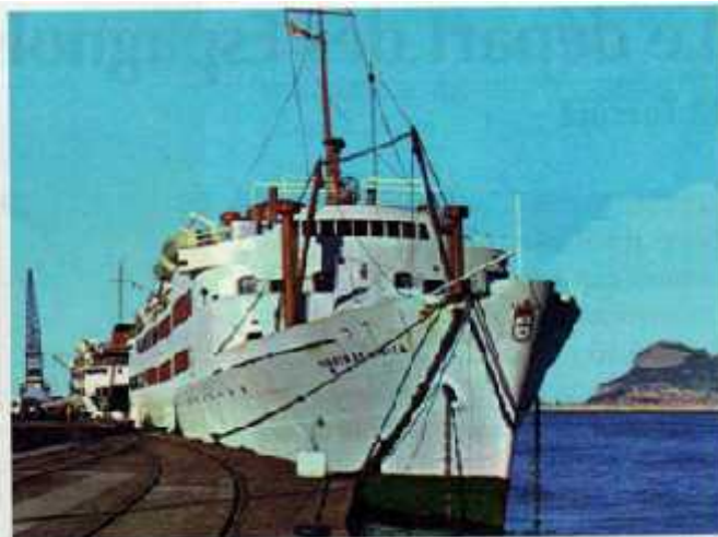
Le MS « Virgen de África » (Compañía Trasmediterránea) : 3.392 tonnes ; 104 m de longueur, 16,56 m de largeur. Vitesse 17 nœuds. Capacité max. : 900 passagers et 100 voitures. Lancé en 1953 et désarmé en 1989. Sister ship du « Victoria ».
