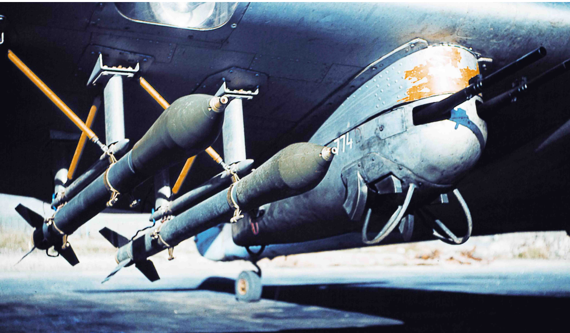
EALA 3/12 – T-6, Roquettes T-10 et conteneur S.A.M.M. S.410 pour deux mitrailleuses MAC 52
