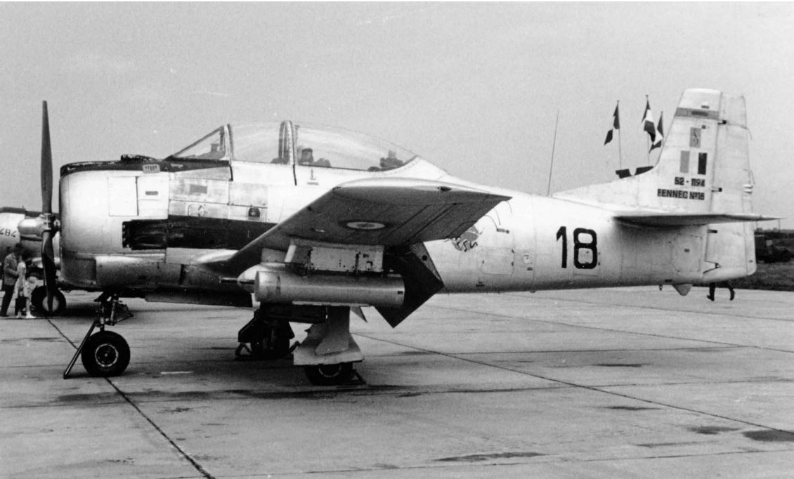
EALA 3/9 – T-28 avec 2 containers x 2 mitrailleuses 12,7 mm et 2 paniers roquettes 37 mm
