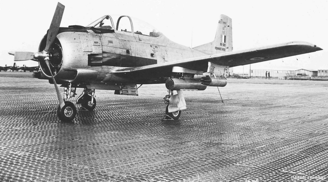
EALA 3/9 – T-28 à Bône, avec deux paniers MATRA de 7 roquettes SNEB de 68 mm et de 36 roquettes SNEB de 37 mm
