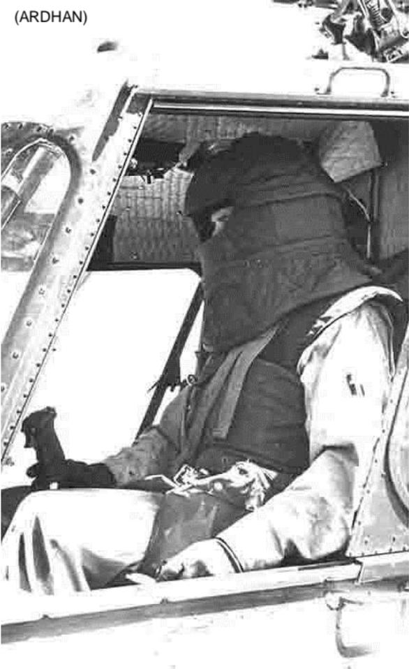
Essai de protection du pilote
