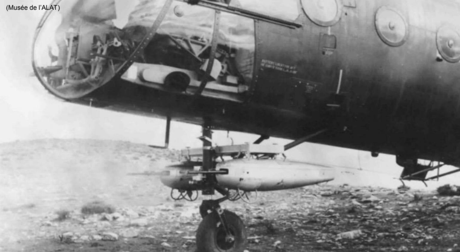
En mai 1968, essai de tir au sol à partir des deux conteneurs SAMM 410 empruntés aux T-6 (quatre mitrailleuses AA 52 de 7,5 mm). Le carénage en goutte d'eau sur le dessus des conteneurs n'existe pas sur les T-6 où le conteneur affleure l'intrados de l'aile. Le support d'un panier de roquettes est visible à droite
