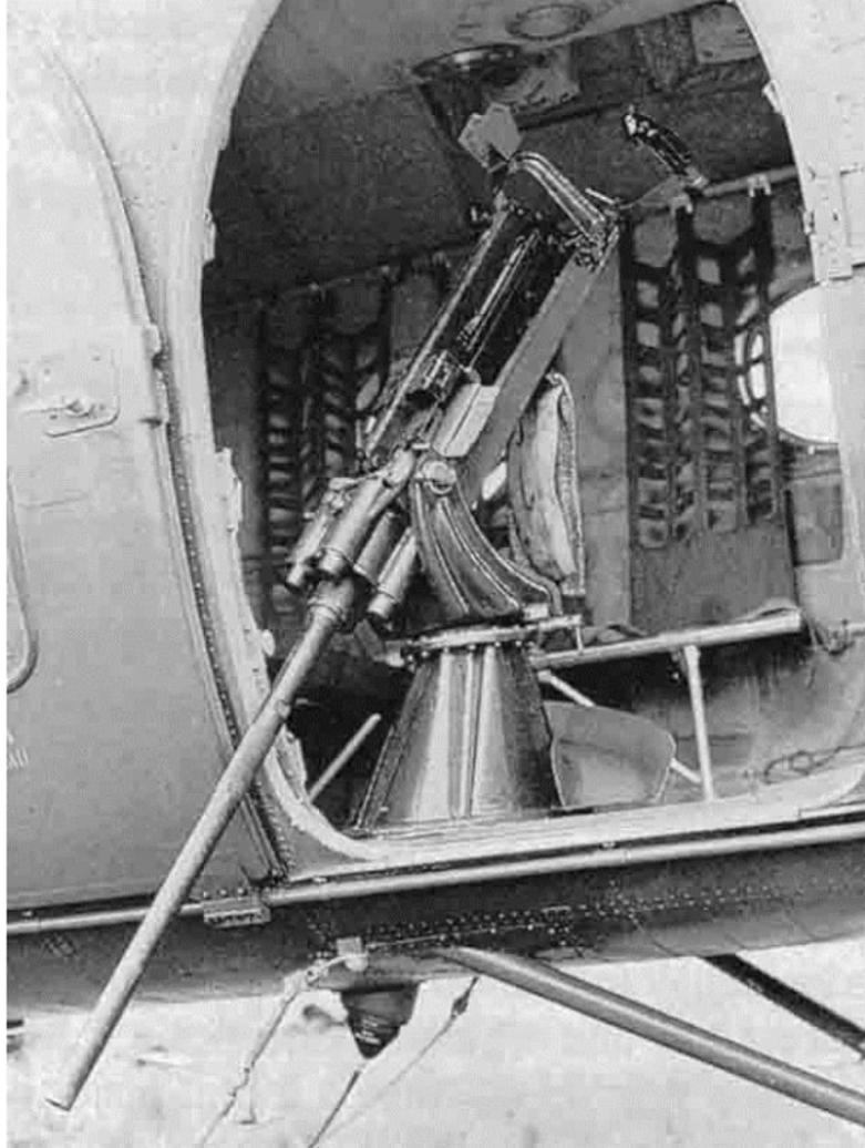
H-21 Couleuvrine – Canon MG 151 de 20 mm sur le support GHAN 60-A (dit *Pot de fleurs*) et le dispositif de frein de recul à l'embase du canon.
