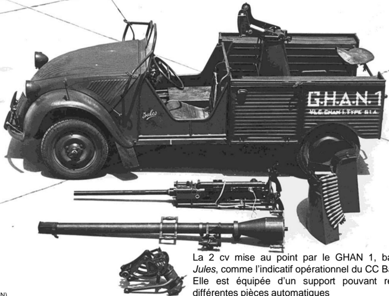
La 2 cv mise au point par le GHAN 1, baptisée *Jules*, comme l'indicatif opérationnel du CC Barbot – Elle est équipée d'un support pouvant recevoir différentes pièces automatiques
