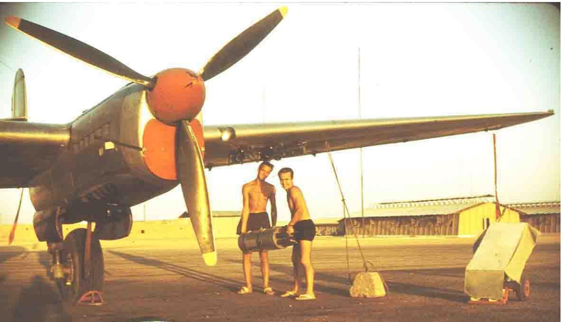
El-Abiod 1961 – Dassault 315 Flamant du GOM 86 – Mise en place d'un panier Matra 122 de sept roquettes SNEB 60 mm
